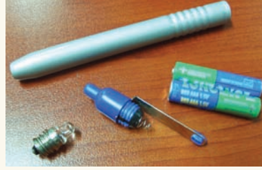
Şekil 4: 2 pilli cep feneri
